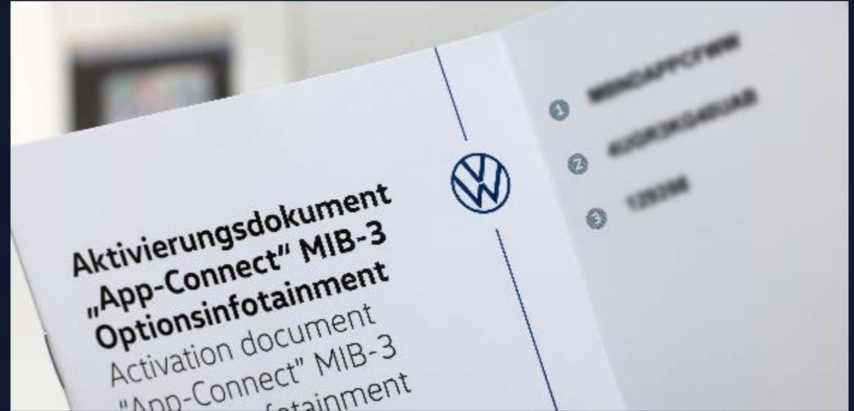
Wenn ein Kunde diese Funktionen nutzen möchte, erwirbt er im Handel das passende SWAP-Produkt, das einen Aktivierungscode enthält. Anschließend wird ein individueller Aktivierungsschlüssel in der Werkstatt auf das Fahrzeug geladen und die Funktion für den Kunden freigeschaltet.
